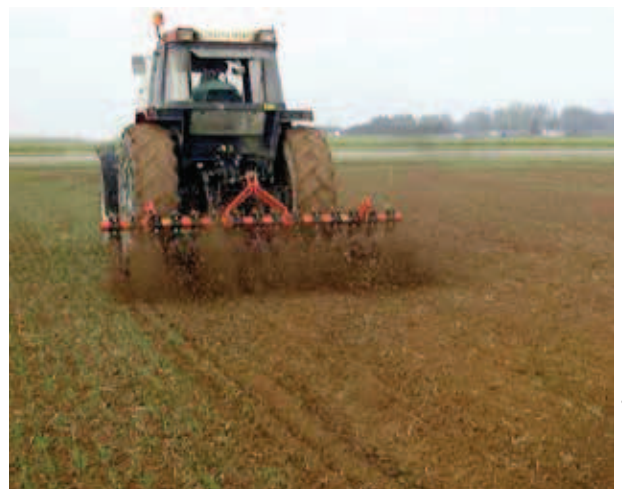
Passage de la houe rotative sur un sol trop humide (terre collant sur roues du tracteur).
